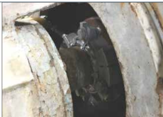
El Sello Bipartido de Cartucho 442C de 114 mm (4.50") se instaló en menos de dos horas.
